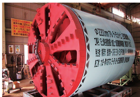
写真－2 本工事で採用した掘進機
