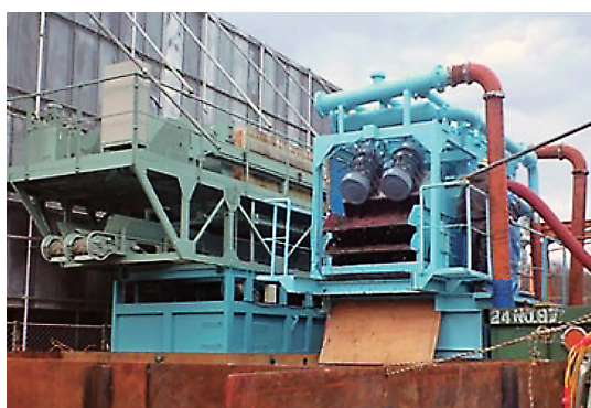
写真-4 フィルタープレス（左）と振動篩（右）
