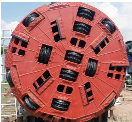
写真-1 ビット交換前（岩盤対応）
