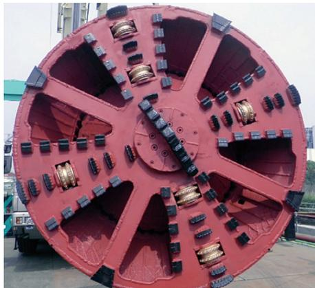
写真-5 巨石土+硬質土カッタ形状
