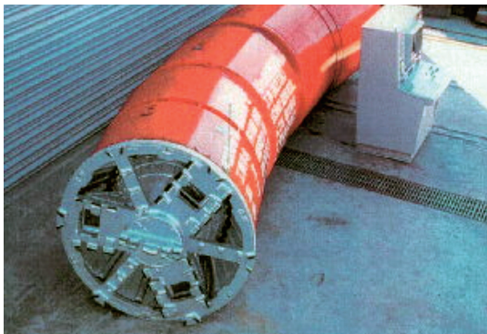
写真-3 急曲線対応掘進機
