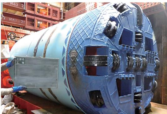
写真-8 機内ビット交換型掘進機
