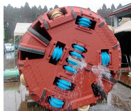
写真-7 削り粉洗浄注水
