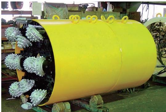
写真-3 玉石用泥濃式掘進機
