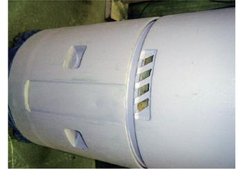
図-1 削り粉の沈殿防止対策の管外吹出し機構
