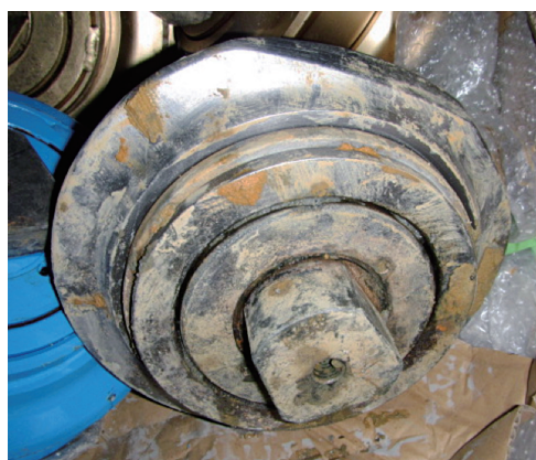
写真－6 偏摩耗の発生したローラカッタ（ディスクカッタ）
