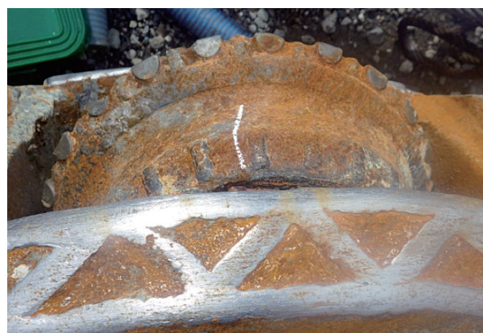
写真-1 ローラカッタ変化（巨石土、チップインサート）
