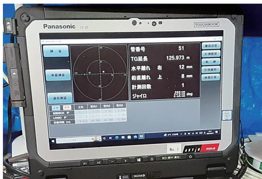
写真-8 立坑オペレータに計測結果を示す自動測量モニター
