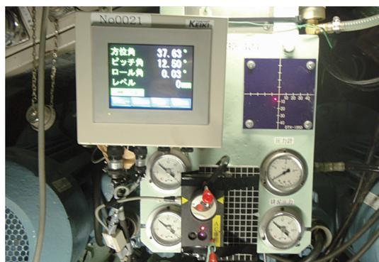
写真-5 リアルタイム測定結果を示すジャイロモニタ
