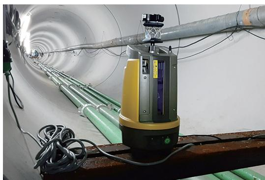
写真-6 推進管内に設置した自動測量管内機
