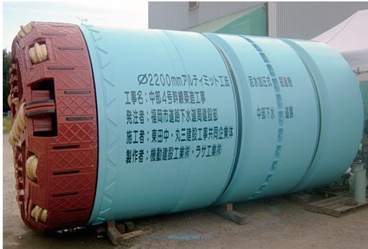
写真-2 多段方向制御方式を採用した急曲線対応掘進機の一例
