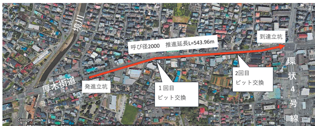
図-1 推進工事概要
