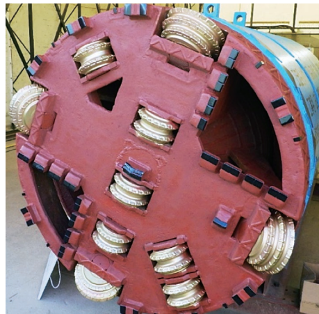
写真-8 軟岩および砂礫土用カッタヘッド
