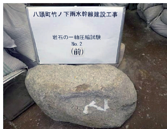
写真-1 巨石強度試験
