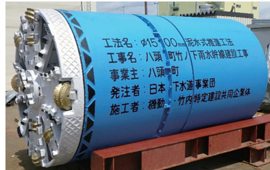
写真-2 泥水式掘進機（当初予定）
