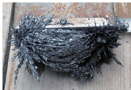
写真-2 切削鉄粉（磁石による吸着）
