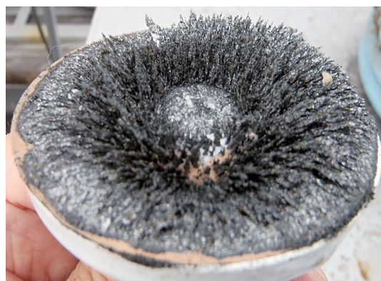
写真-5 鋼矢板切削鉄粉（磁石による吸着）
