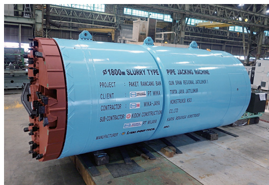
写真-7 出荷を待つ掘進機
