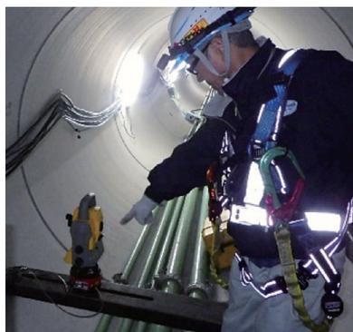
写真-15 自動測量機 (管内配置)
