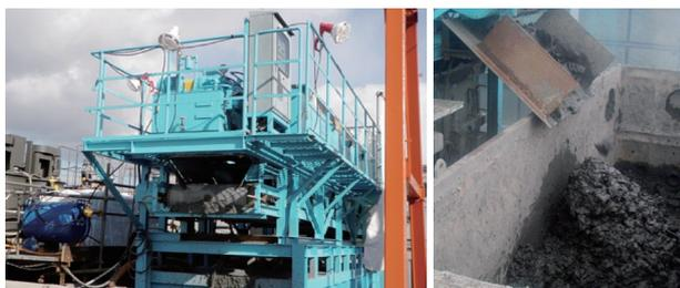
写真-2 二次処理機(加圧脱水式:脱水ケーキ排土状況)
