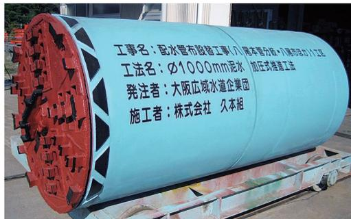
写真-9 泥水式掘進機
