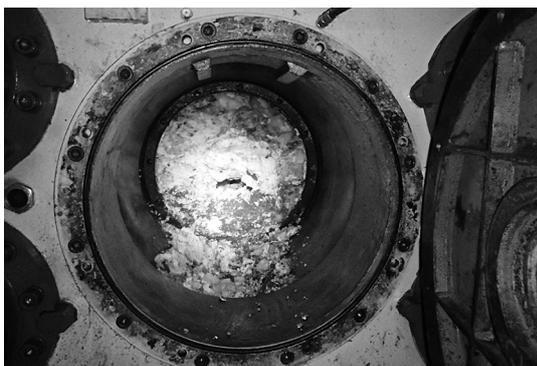
写真-4 薬液注入後、チャンバ内
