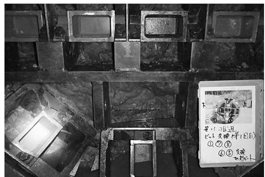
写真-6 1回目ビット交換（固定ビット取付け）
