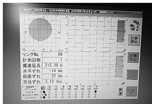
写真-7 自動測量管理画面の例
