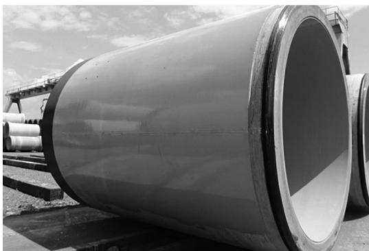
写真-11 摩擦低減剤を塗布した管
