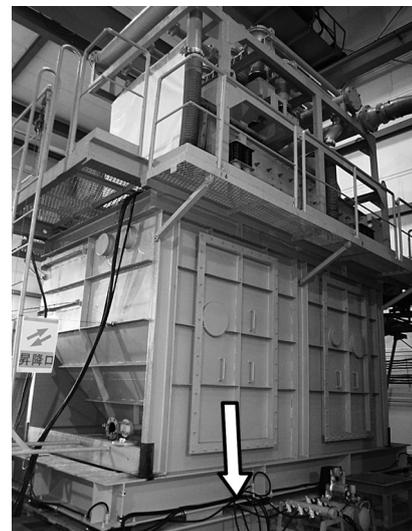
写真-16 泥水振動篩のエアダンパ
