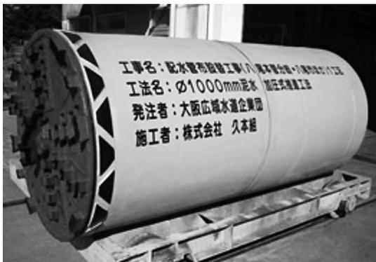
写真-1 泥水式掘進機
