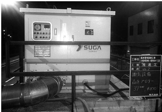
写真-7 換気設備 (高圧プロア37kw)
