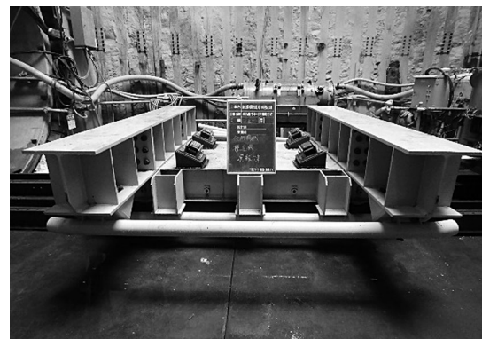
写真-5 運搬台車兼用推進架台
