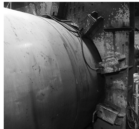
写真-3 バッキング防止油圧ジャッキ押付け方式
