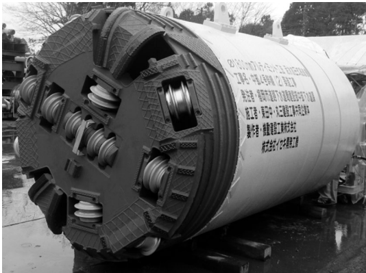
写真-4 呼び径1800アルティミット工法・泥水式掘進機 (岩盤・曲線用機内ビット交換用掘進機)
