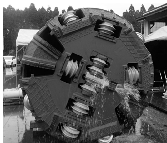
写真-3 面板洗浄ライン噴出状況
