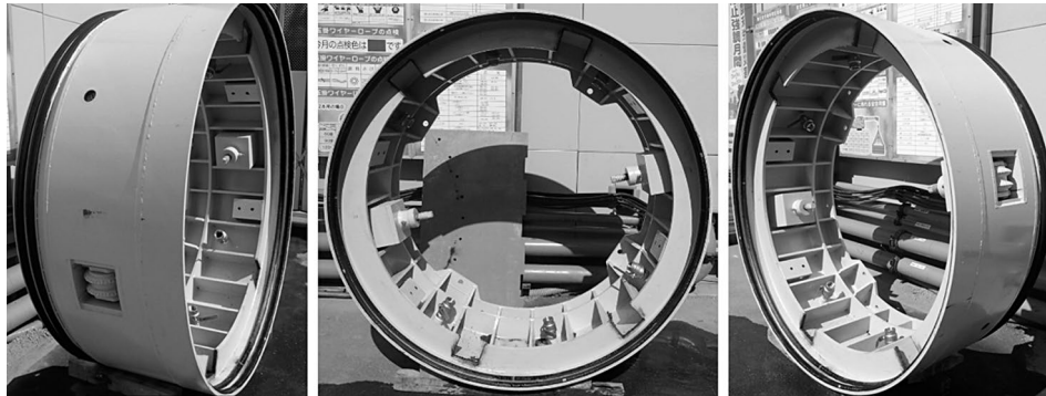
写真-9 ローリング防止・テールボイド洗浄用補助設備筒
