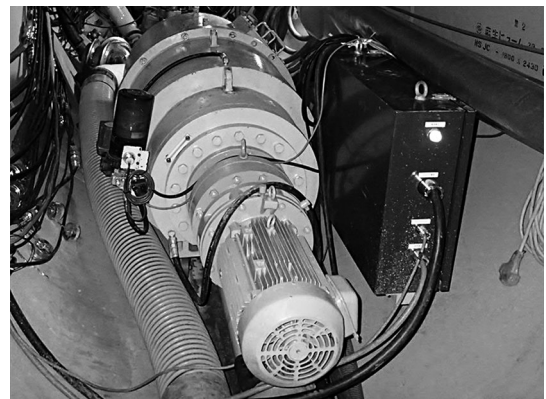
写真-8 偏芯破碎型ラインクラッシャ
