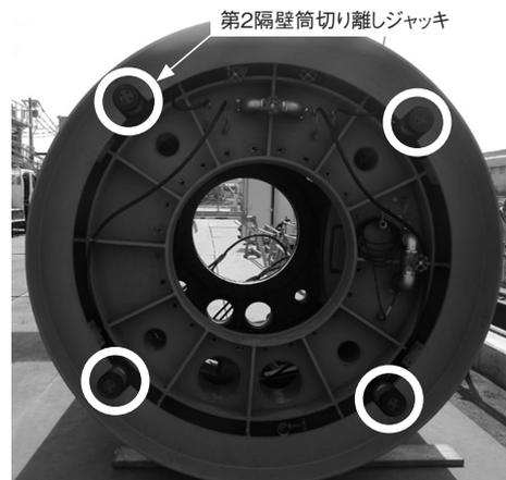
写真-9 第2隔壁筒（後部）
