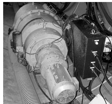
写真-3 偏芯破碎型ラインクラッシャ
