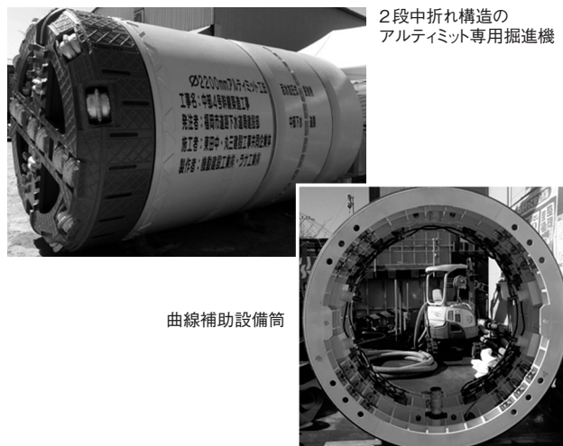
写真－7 岩盤急曲線用アルティミット掘進機、曲線補助設備筒
