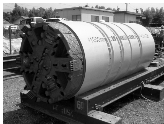
写真－5 1スパン1,260mを施工した二重管推進工法の掘進機 3)
