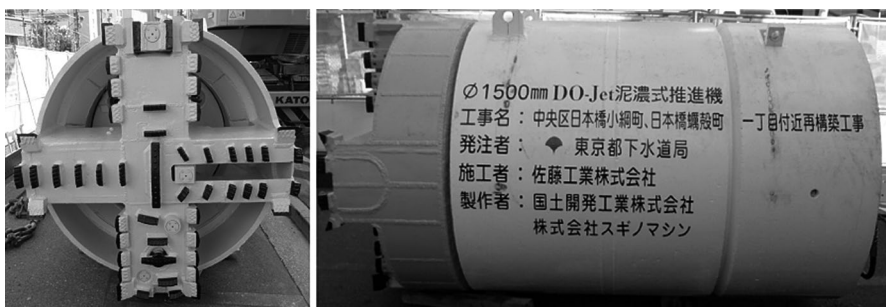
写真-4 掘進機前面および側面
