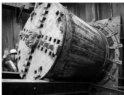
写真－8 掘進機押し出し
