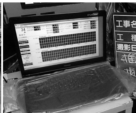
掘削土量管理システム表示
