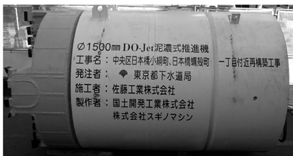
写真-17 掘進機前面および側面
