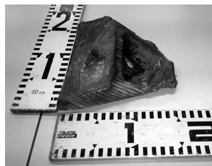
写真-18 搬出した切断材
