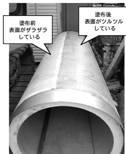
写真-13 マニキュア剤塗布前後のコンクリート管
