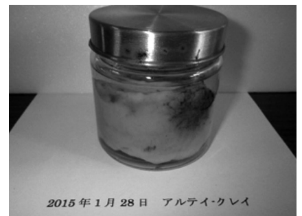
写真-4 アルティークレイ(海水中2年4箇月後)(海水内で2年以上経過後も溶出無く流動性を維持。表面には徴が付着)
