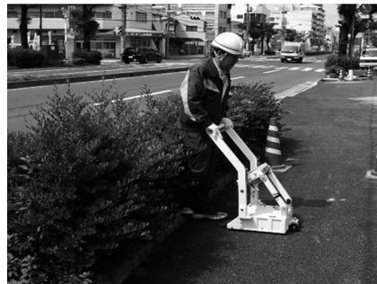
写真-1 電波探査
