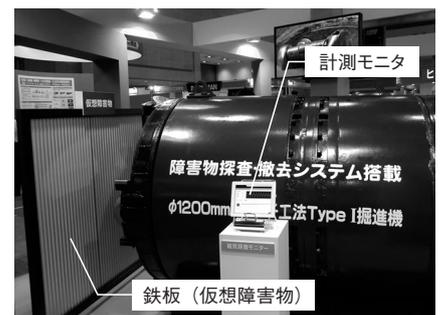
写真-4 掘進機による探査と支障物切削
