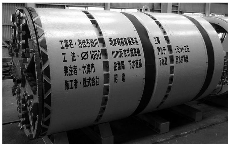
写真-1 泥水式掘進機（アルティミット工法）全景
