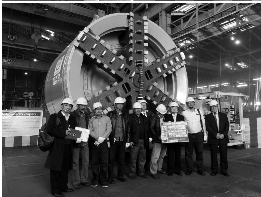
写真-4 掘進機立会検査の様様
