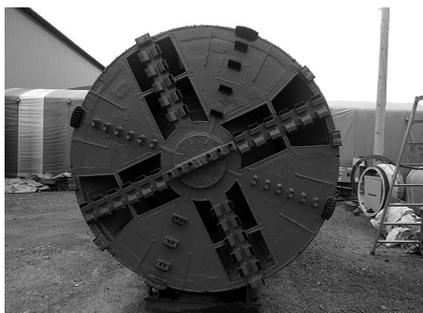
写真-4 泥水掘進機カッタフェイス
