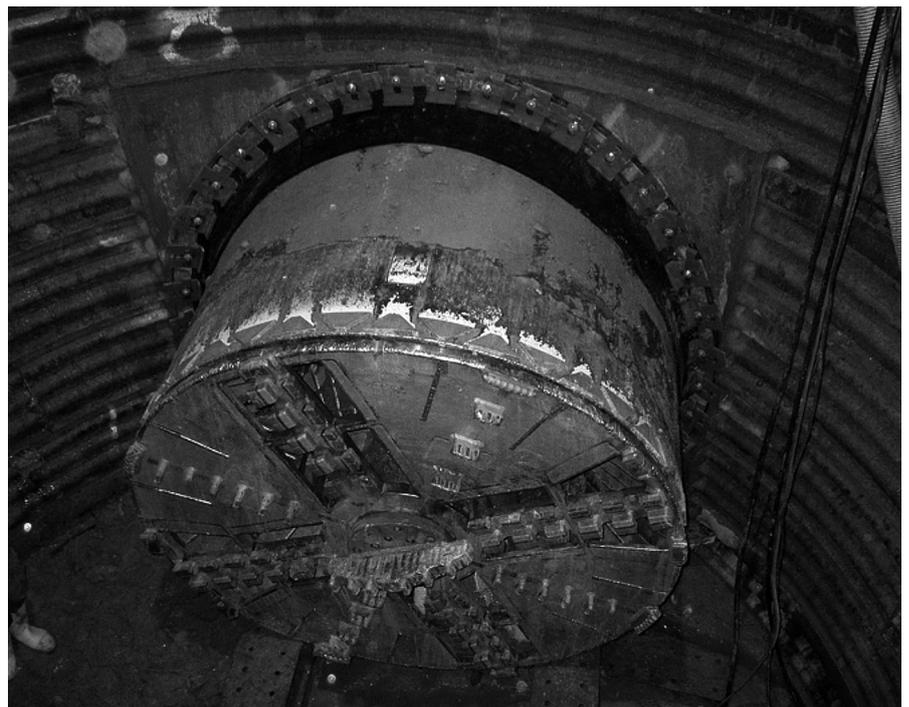
写真-5 泥水掘進機カッタフェイス
