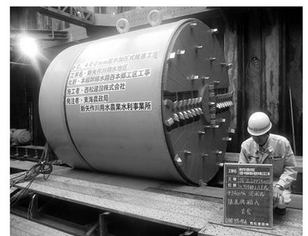
写真-1 急曲線用泥水掘進機
