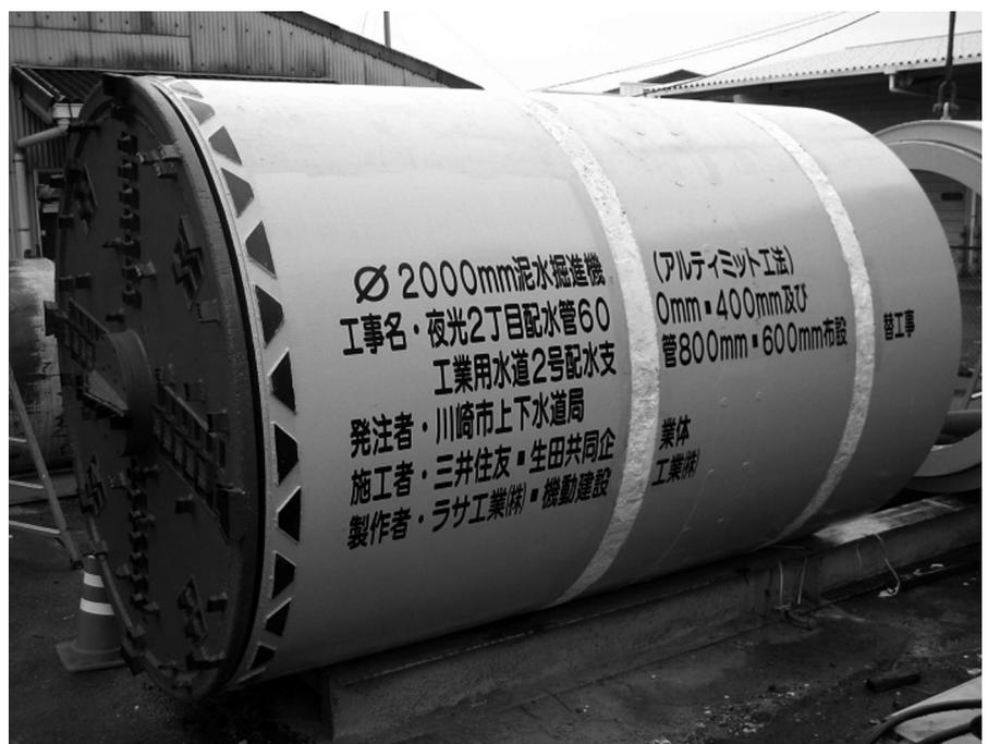
写真-1 急曲線用泥水式掘進機
