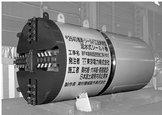
写真-2 ハイブリッド掘進機（全景）
