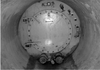
写真一2 第2隔壁（水中回収システム）
