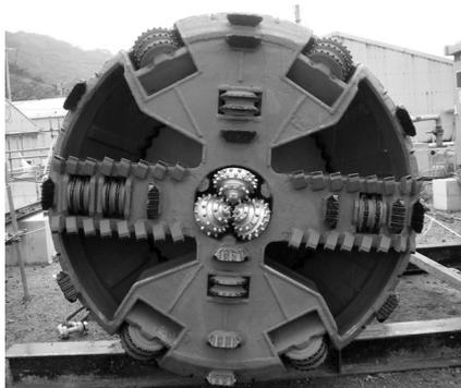
写真-1 泥水式掘進機
