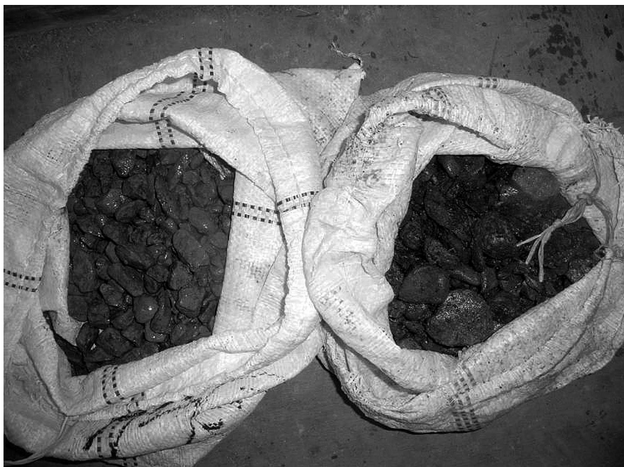
写真-6 掘削残土比較 (左：ラインクラッシャ使用後、右：ラインクラッシャ使用前)
